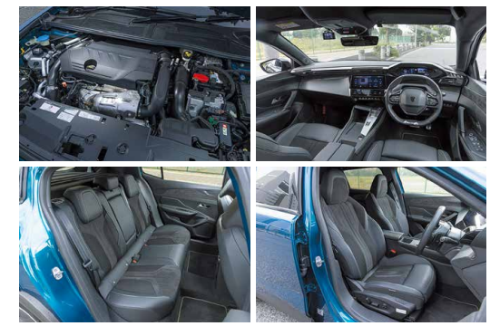
ブラック基調のインテリアは、10インチタッチスクリーンと小径ステアリングを組み合わせたブジョー独自設計の「iCockピット」を採用する。PHEVモデルは180ps/250Nmの1.6ℓ直列4気筒ターボのハイブリッドシステムを搭載。
