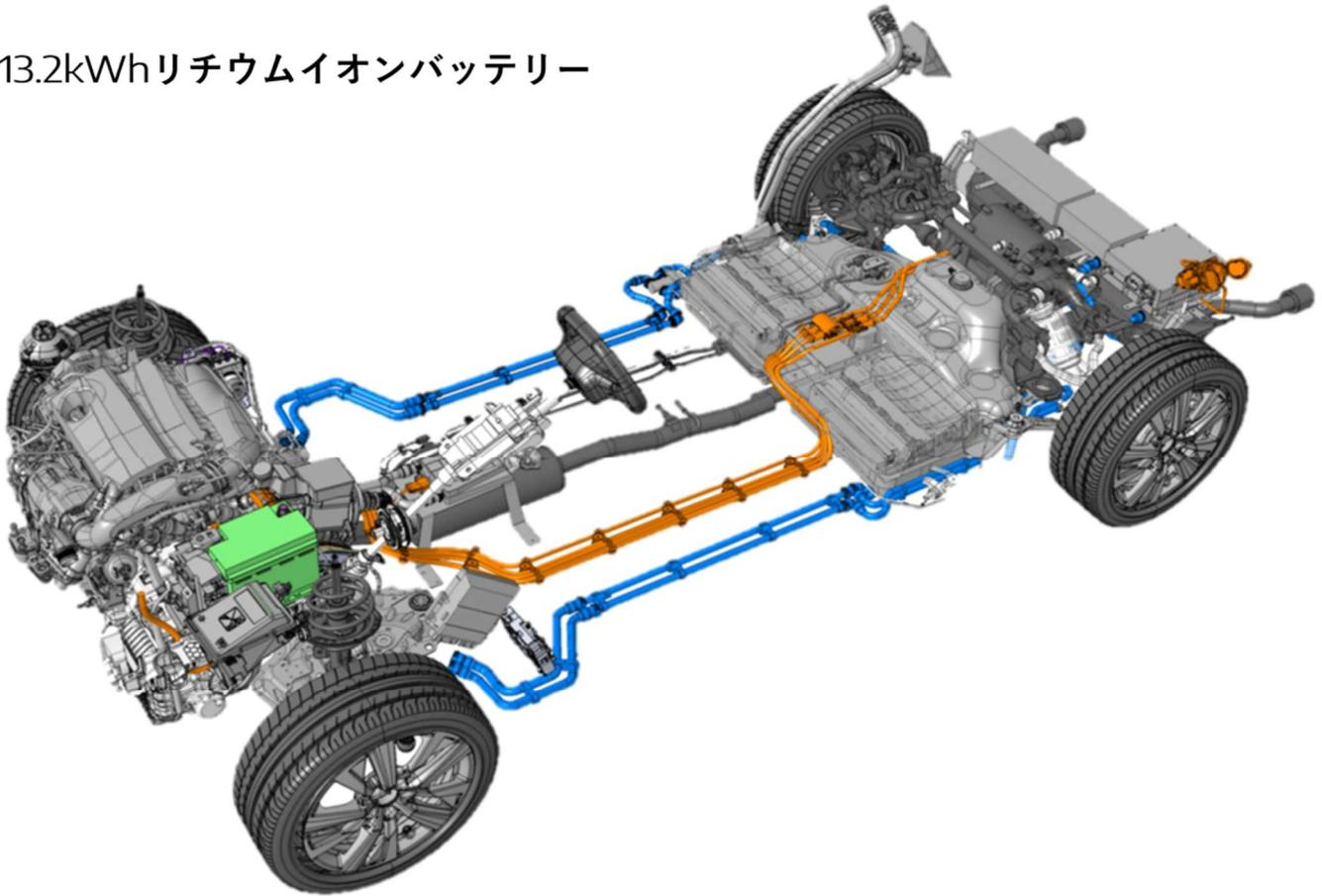
車両の高電圧ケーブルは、被覆をオレンジ色で統一しています。
