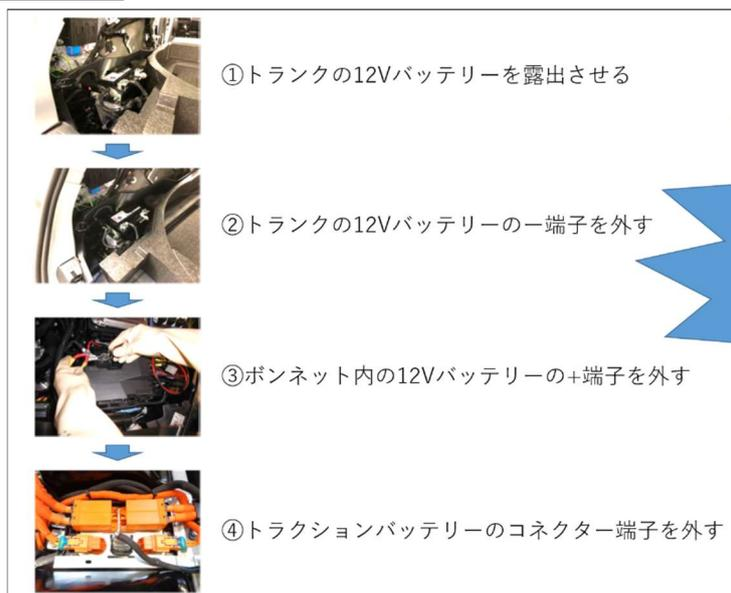
**12Vバッテリーの端子を外す際は必ずトランクの12Vバッテリーから外すこと！**
